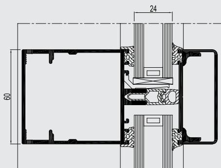
El CW 60 es un excelente sistema de muro cortina con rotura de puente térmico para grandes superficies de vidrio (los módulos pueden soportar un peso de hasta 450 kg por panel de vidrio), construcciones inclinadas, verticales o curvadas y especialmente para proyectos de rehabilitación.
