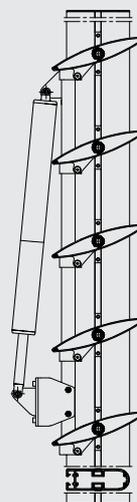
Los sistemas BS (Brise Soleil) de Reynaers se han diseñado para proporcionar solución de sombreado estética y eficiente ya sea en obra nueva o en un edificio existente. Se ofrecen como solución estándar o a medida. Brise Soleil es el término genérico para un sistema de lamas las cuales, una vez colocadas en la fachada externa de un edificio, proporcionan una protección contra la radiación solar y la luminosidad excesiva.
