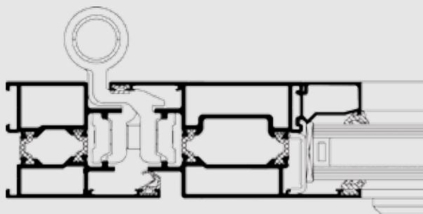
El CS59-CD es un sistema de tres cámaras con rotura de puente térmico exclusivamente para la realización de puertas, utilizando bisagras guiadas. Su extensa gama de perfiles permite fabricación de cerramientos atractivos y económicos.
